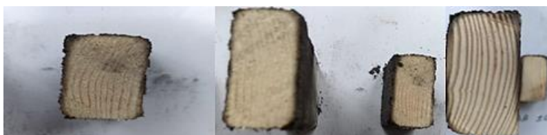
Рисунок 2 – Результати дослідження ефективності вогнезахисту антипіреном комплексної дії Амок-1
