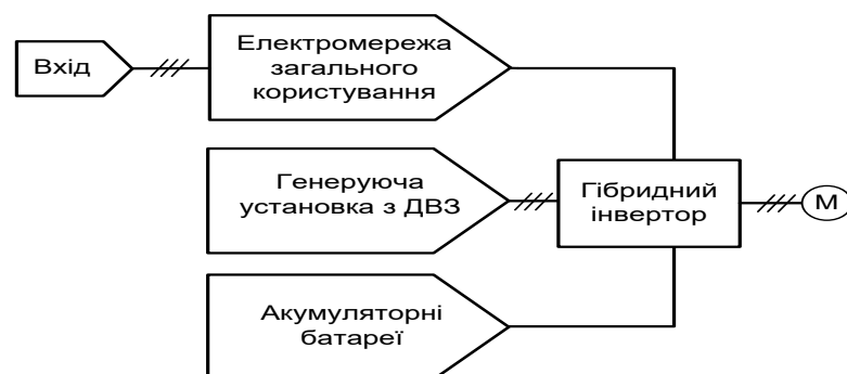
Рис. 1. Схема живлення систем протипожежного захисту
