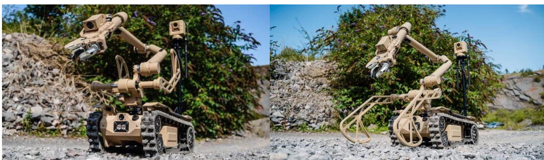
Рис. 1 Британські багатофункціональні роботи типу L3Harris T4
