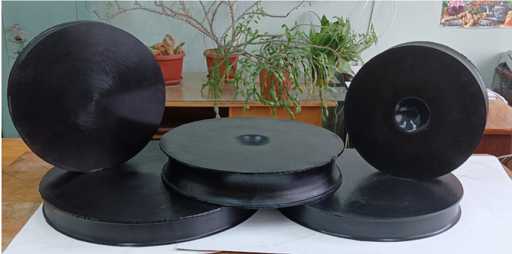
Рисунок 1 – Приклад вібросейсмоелементів що розроблялись, випробовувались та використовувались у будівництві
