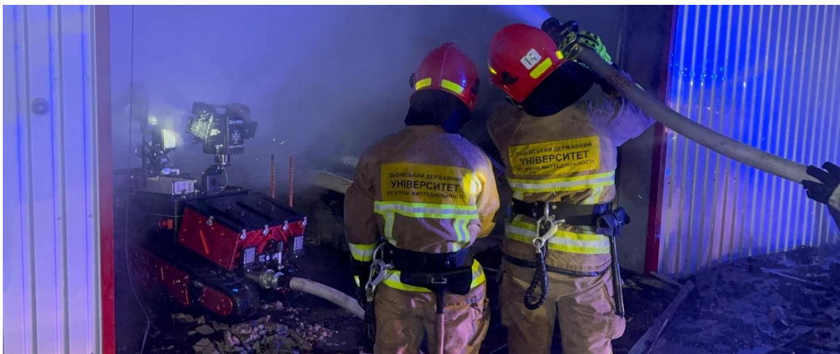
Рисунок 1 – БпНРК в умовах ліквідації пожежі складських приміщень
