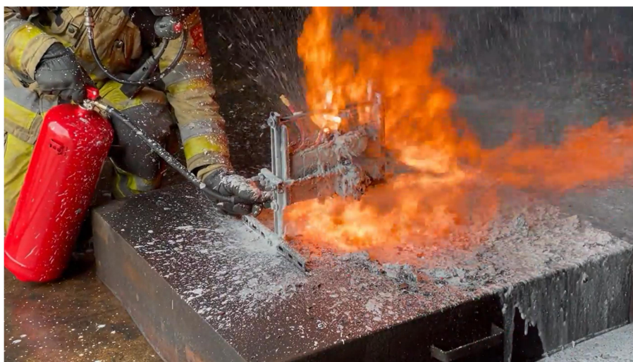
Рисунок 2 – Процес гасіння літій-іонних акумуляторів
