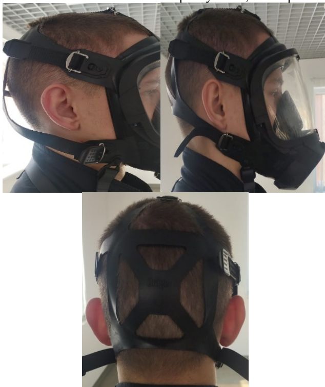
Рисунок 1 – поетапне налаштування панорамної маски газодимозахисником
