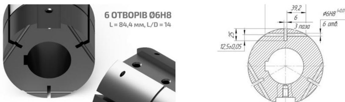
Рис. 1 – Приклад деталі із глибокими отворами у криволінійних поверхнях
