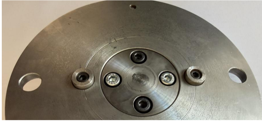
Рис. 2 – Ілюстрація технічного рішення з використанням циліндричних шпонок
