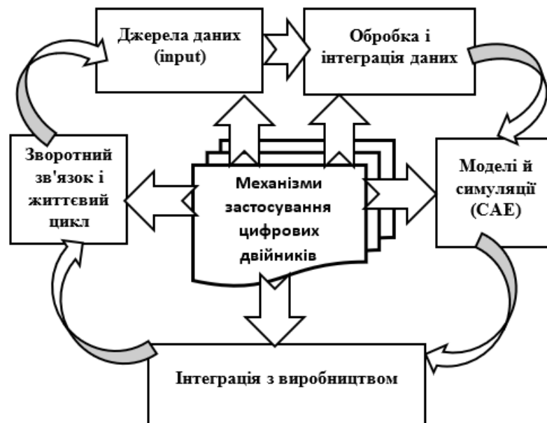
Рис. 1 – Механізми застосування цифрових двійників у виробничій системі відновлення виробу
