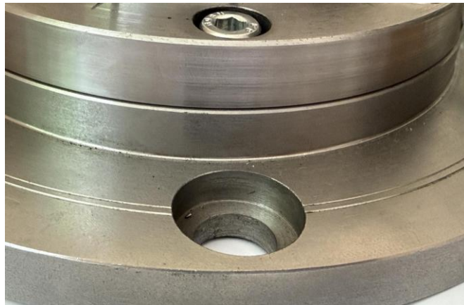
Рис. 3 – Ілюстрація технічного рішення з використанням східчастих отворів для закріплення пристрою на верстаті
