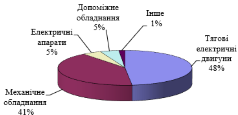
Рисунок 1 – Розподіл пошкоджень обладнання приписного парку електровозів депо «Харків-Головне»
