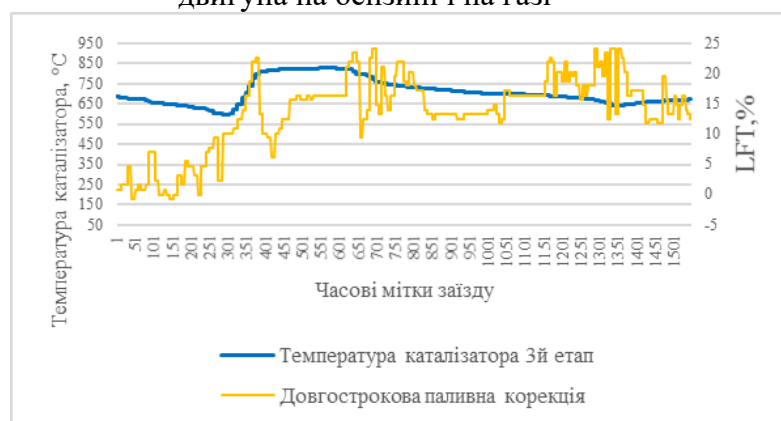
Рисунок 2 – Комбінована діаграма зміни довгострокової паливної корекції LFT при роботі двигуна на бензині та зміна температури каталізатора
