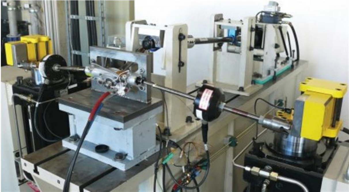
Рисунок 1 - Устаткування для випробування окремих елементів гідроприводу автомобіля
