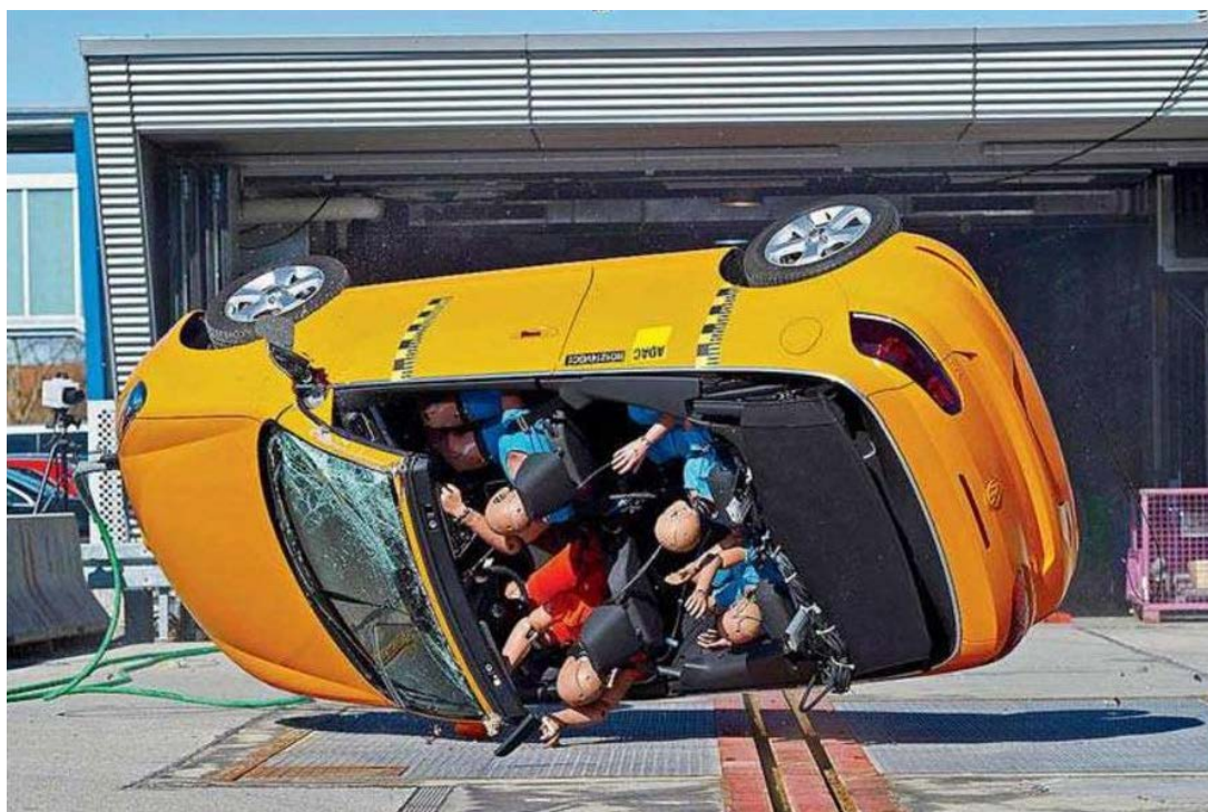
Рисунок 1 – Приклад використання «сім'ї манекенів» (дітей і дорослих) при випробуванні кузова кабриолета на перекидання
