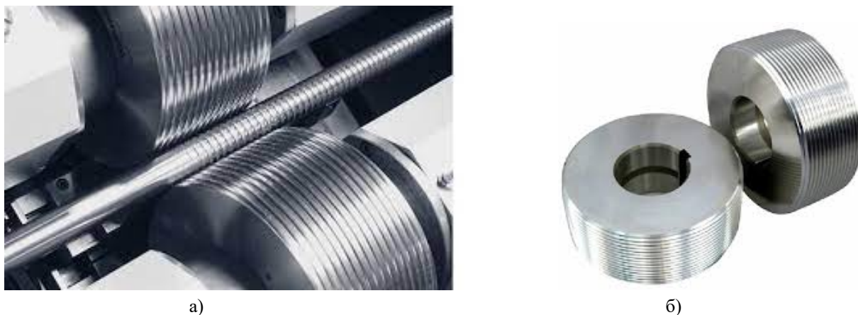
Рисунок 1. Процес накатування зовнішньої різі (а), різенакатні ролики (б)
