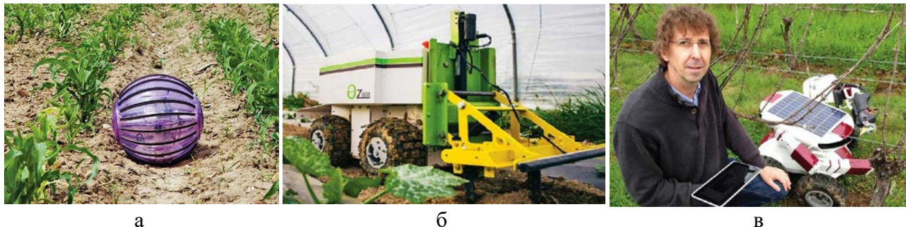
Рисунок 1 – Загальний вигляд агророботів: а – сферичний робот Rosphere для моніторингу посівів; б – робот Oz для міжрядного обробітку; в – робот для обрізки виноградної лози Wall-Ye
