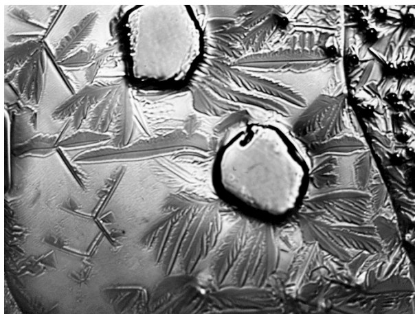
Рисунок 1 – Мікроструктура сталі типу Р6М5 після теплового вакуумного травлення, x1000
