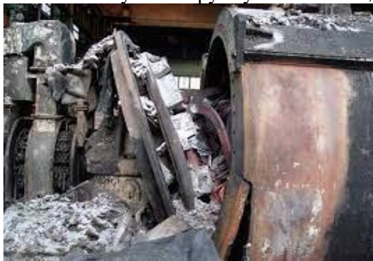
Рисунок 3 – Наслідки вибуху водню при витоку через картери підшипників турбогенератора
