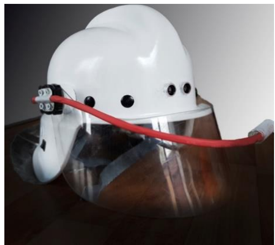
Рисунок 13 – Будова пристрою для орієнтації в умовах обмеженої видимості (а) та експериментальний візирець (б): 1 – каска, 2 – ультразвуковий датчик, 3 – гнучкий кронштейн, 4 – екран, 5 вимикач живлення, 6 – мікропроцесор (всередині каски), 7 – блок живлення (всередині каски).
