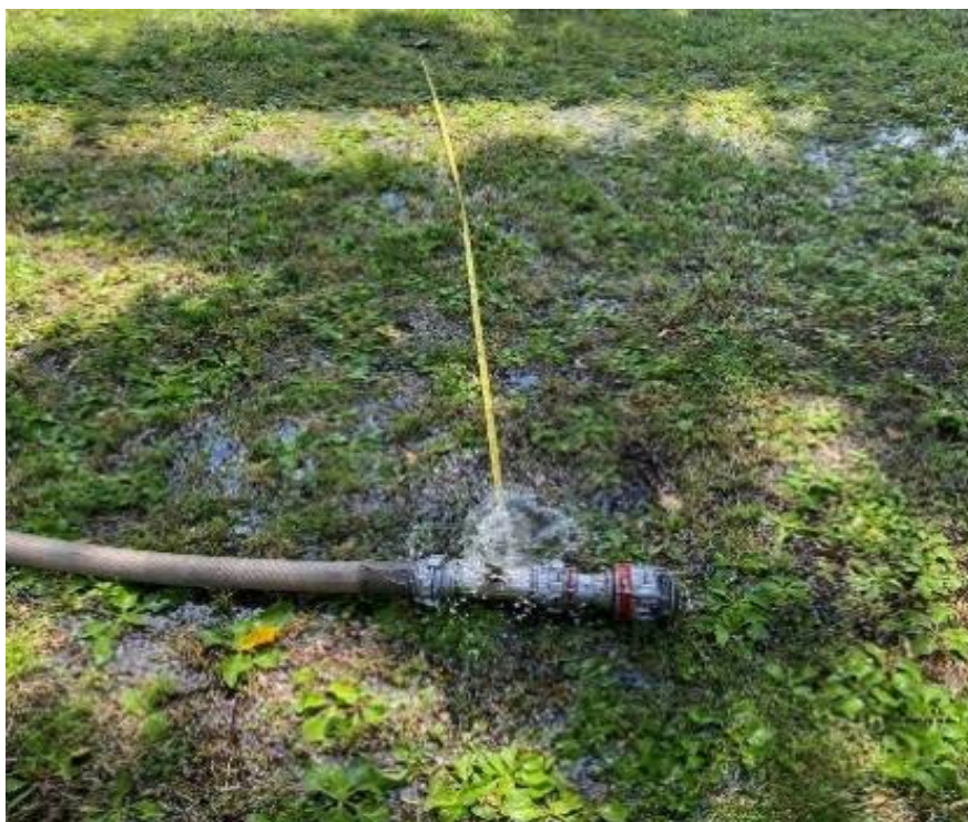
Рисунок 4.4 – Дослідження радіуса розпилення вогнегасної речовини пристроєм для створення водяної завіси
