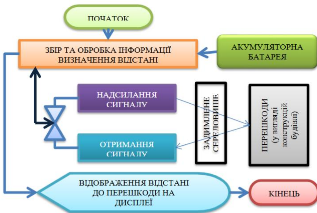
Рисунок 4.13 – Алгоритм роботи системи орієнтування у задимленому середовищі
