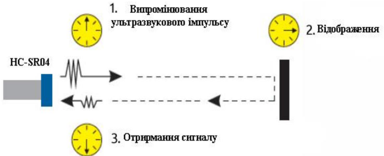
Рисунок 4.11 – Принцип роботи ультразвукового датчика відстані
