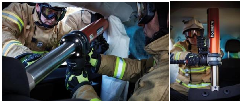
Рисунок 1 – Встановлення телескопічного домкрата для стабілізації конструкції автомобіля
