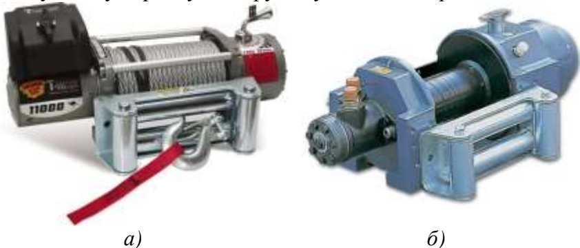
Рис. 1.22. Автомобільні лебідки: а) електрична; б) гідравлічна
