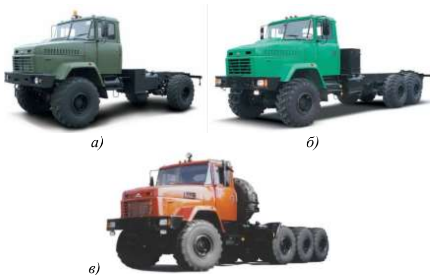
Рис. 1.16. Повноприводні шасі КрАЗ з колісними формулами: а) 4х4; б) 6х6; в) 8х8
