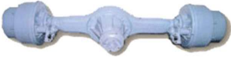
Рис. 1.38. Ведучий міст Т-155 з колісними редукторами
