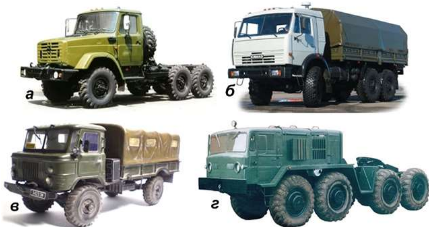
Рис. 1.12. Приклади розташування двигунів автомобілів підвищеної прохідності відносно кабіни:
