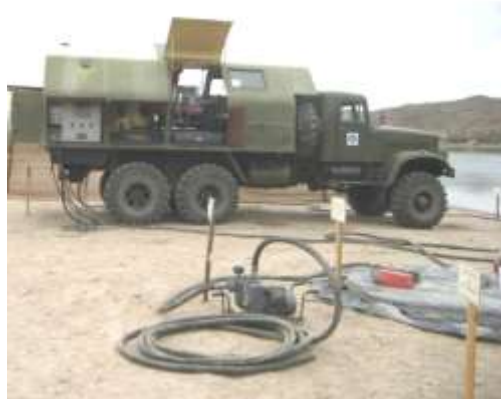
Рис. 2.30. Опріснювальна станція ОПС
