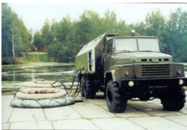
Рис. 2.40. Опріснювальна станція ОПС-5
