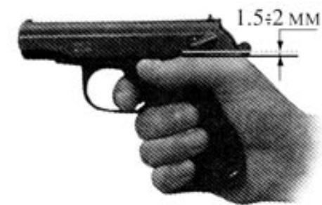
Рис 20 Зсув запобіжника вгору (постріл не відбувається)
