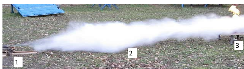
Рис. 3. Конечная фаза тушение газового факела импульсной струей жидкости.
