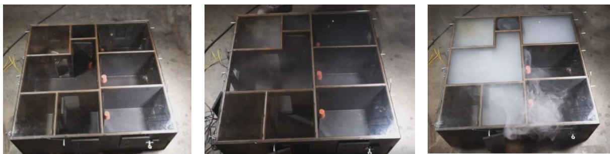
Рис.1. Макет процесу розповсюдження продуктів горіння на пожежі
