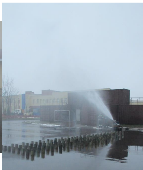
Рисунок 1 – Определение эффективной дальности распыленной струи ствола СПРУК 50/0,7 «Викинг»
