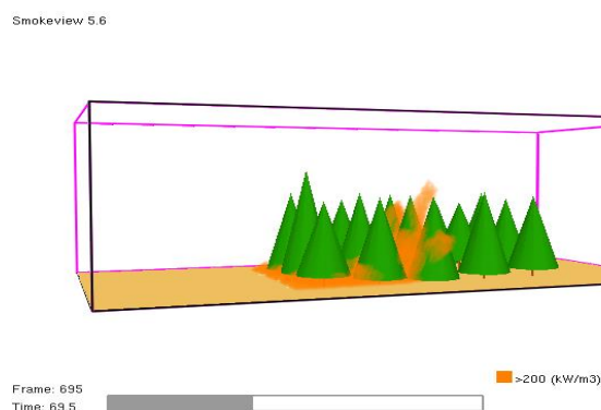
Рис. 1 Візуалізація результатів моделювання пожежі в соснових насадженнях у молодому віці в середовищі WFDS
