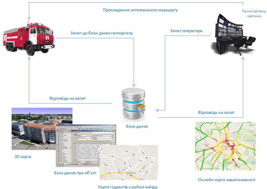
Рис. 1. – Схема роботи геопорталу для покращення швидкодії підрозділів ДСНС
