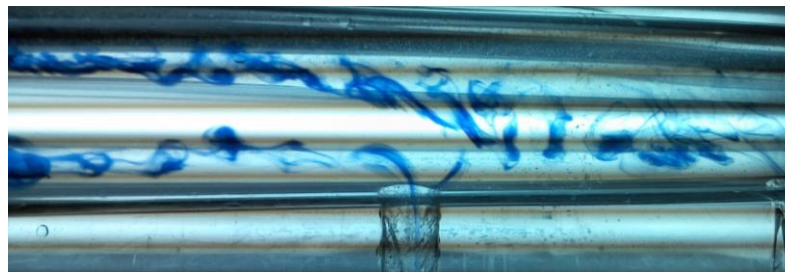
Рис. 2. Дестабилизация течения в потоке за насадкой при числах Рейнольдса Re > 1500
