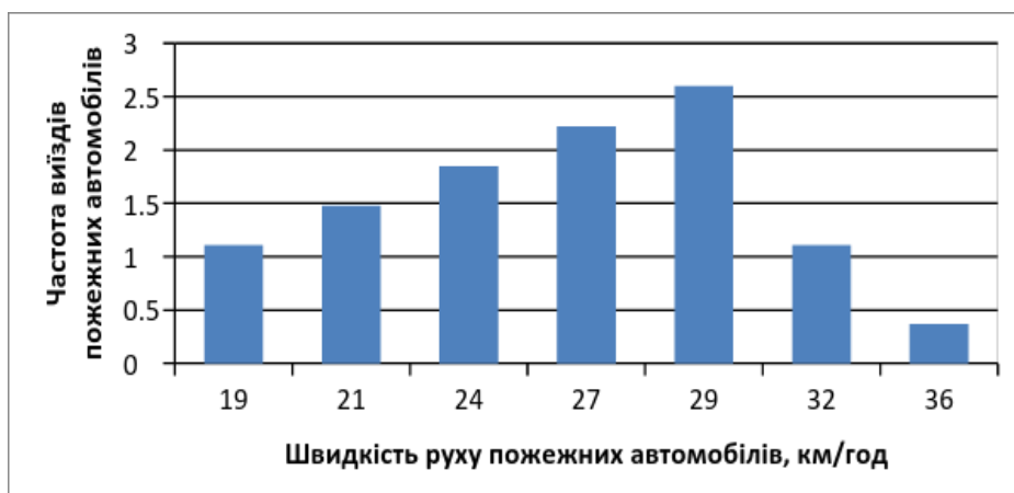
Рисунок 1 – Гістограма розподілу швидкості руху пожежних автомобілів до місця пожежі в м. Васильків в 2013 р.
