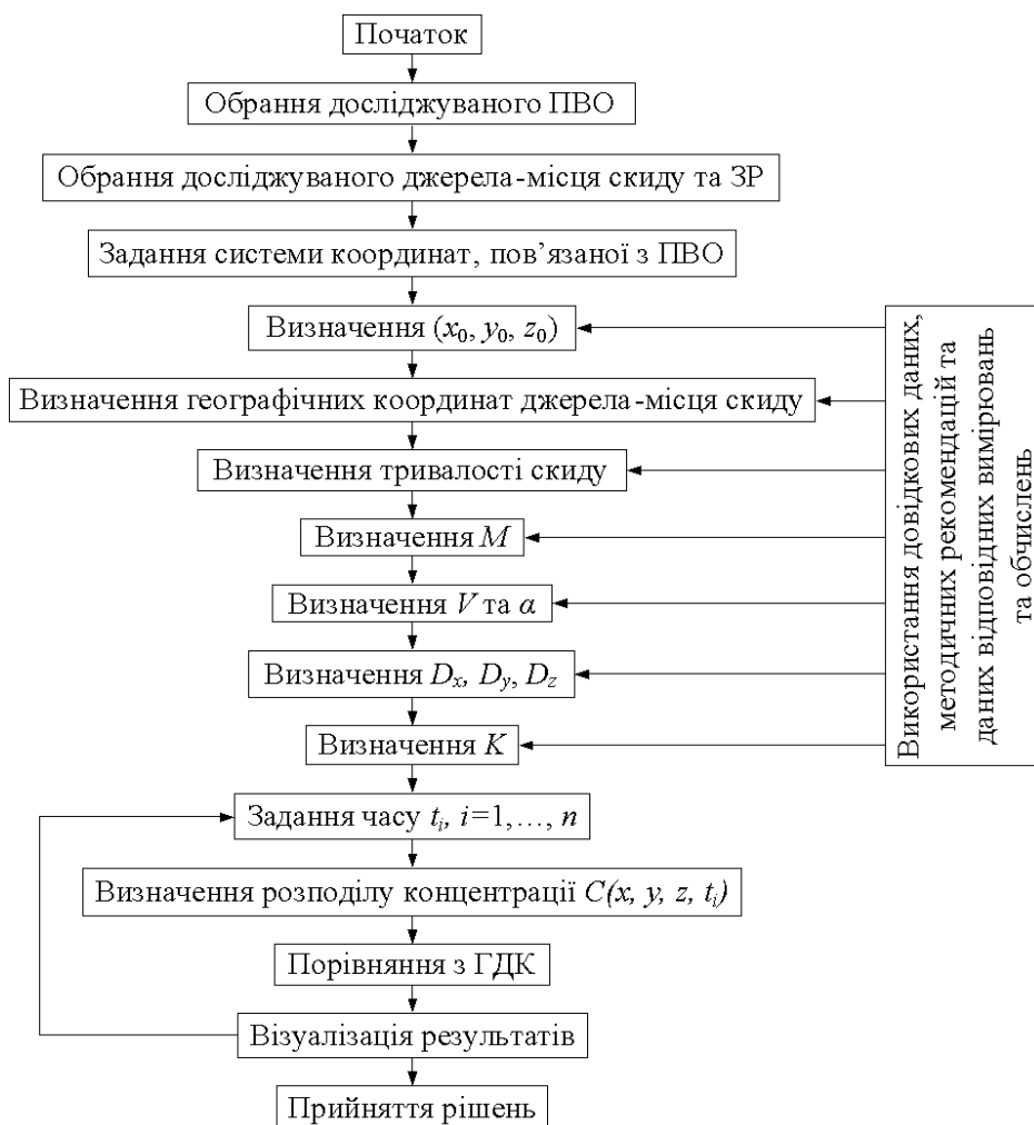
Рисунок 1 – Схема керуючого алгоритму за нестационарних умов скиду
