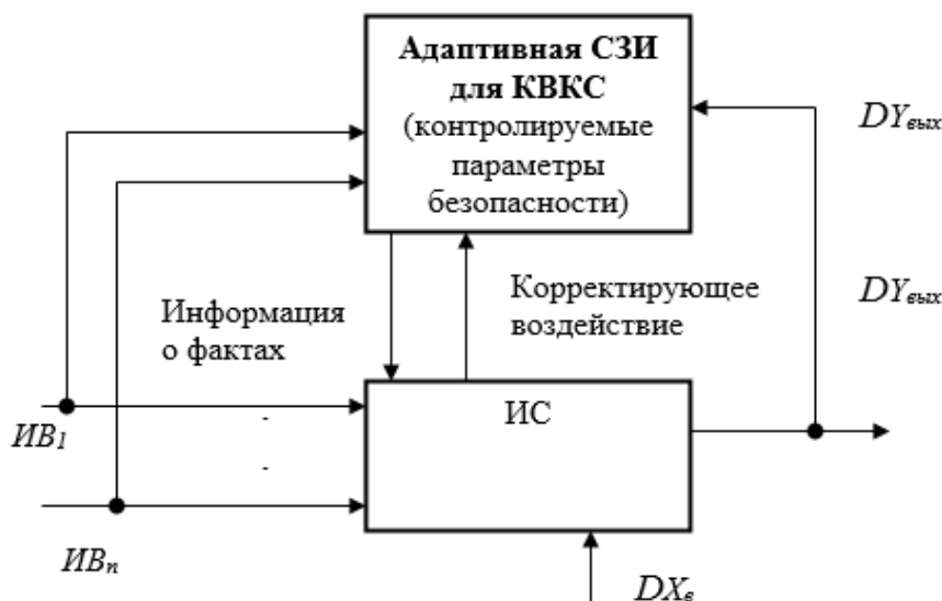
Рис. 6. Схема адаптивной системы защиты информации КВКС
