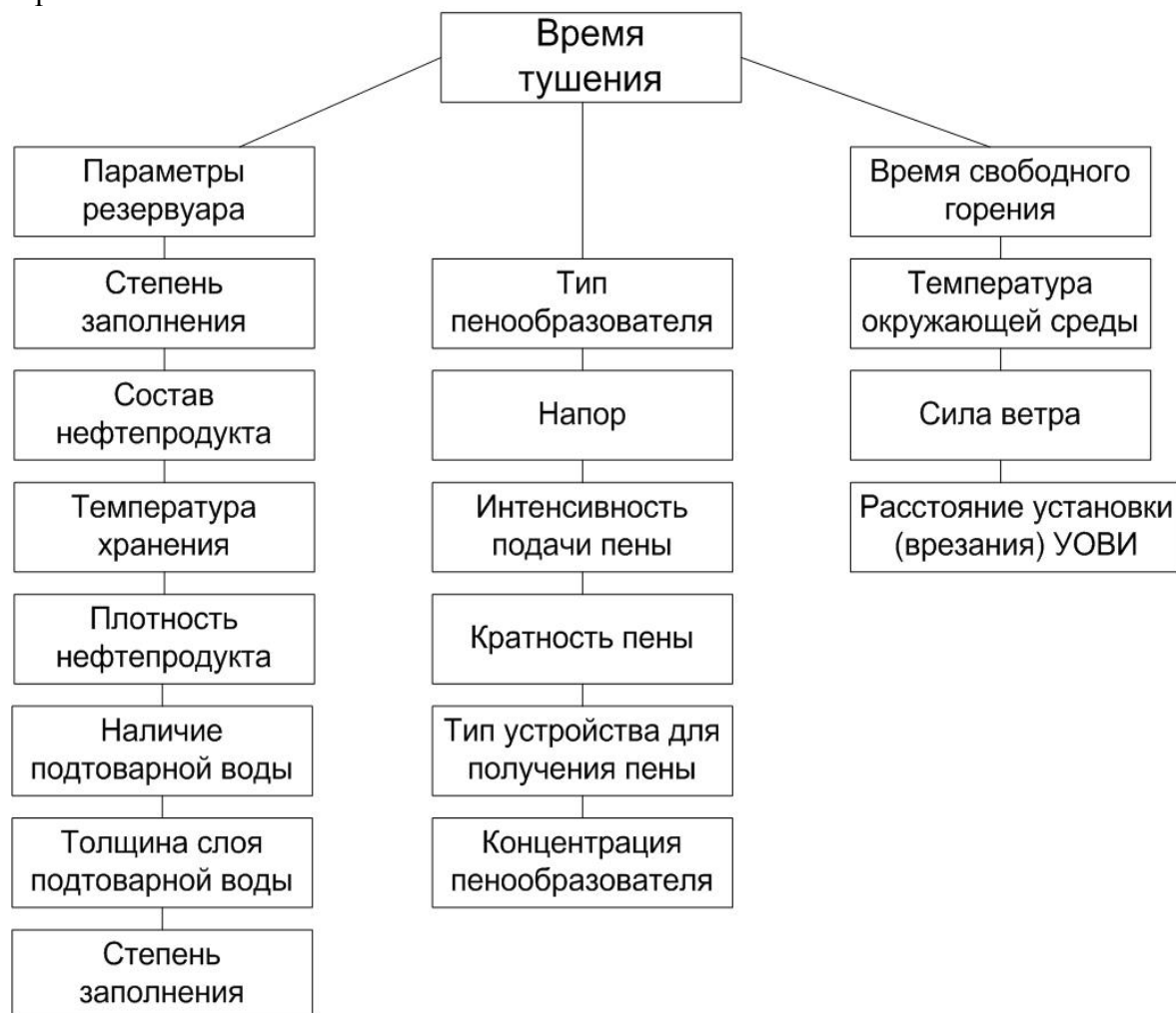
Рисунок 1 – Факторы, определяющие эффективность подслоного тушения
