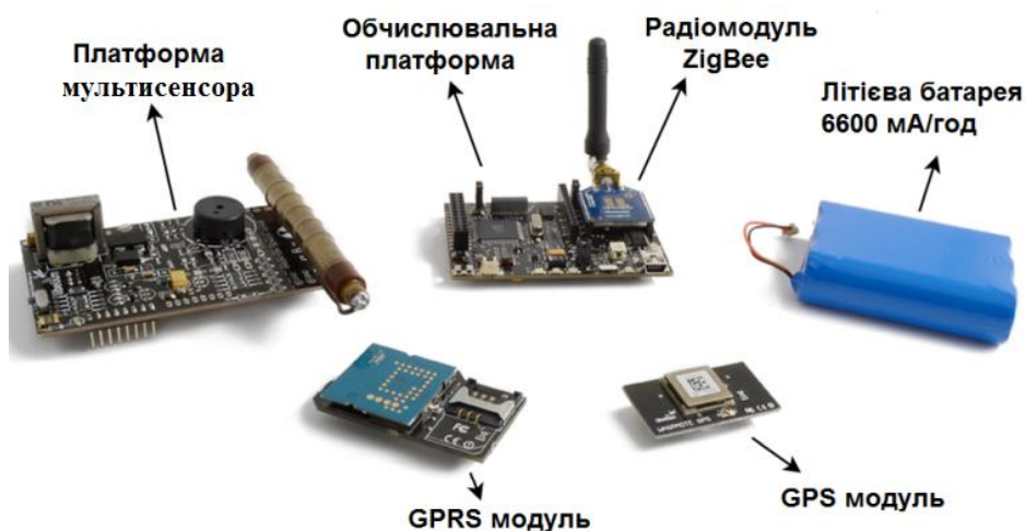
Рис. 9 Типова комплектація інтелектуального сенсорного пристрою
