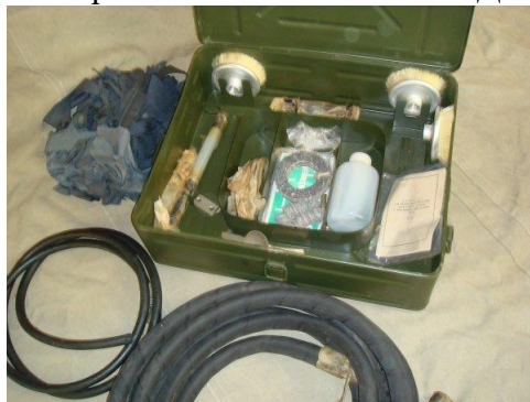
Рис. 1 – Автомобільний комплект для спеціальної обробки військової техніки ДК-4
