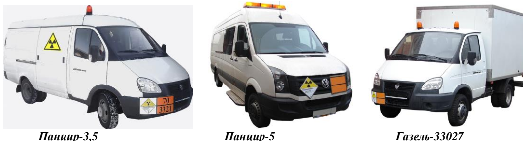
Рис. 1 – Цільнометалеві фуртони для перевезення ТПК з радіоактивними речовинами і ДІВ
