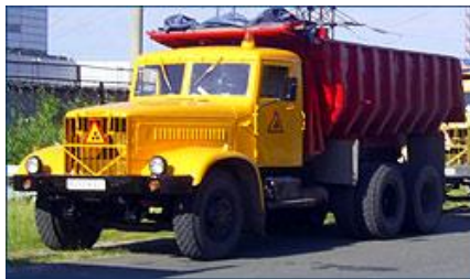
Рис. 3 – Спецавтомобіль для перевезення радіоактивних відходів КрАЗ-256В-1
