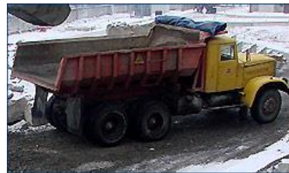
Рис. 3 – Спецавтомобіль для перевезення радіоактивних відходів КрАЗ-256В-1
