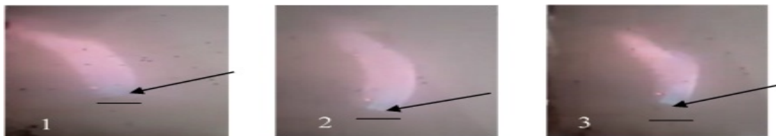
Рис. 3.5 Вплив комбінованої суміші на кінетичне полум'я н-гептану: 1 – горіння полум'я при добавці аерозолю – 45 г/м 3 , азоту – 10 %; 2 – відрив полум'я на 4мм при добавці аерозолю – 45 г/м 3 , азоту – 15 %; 3. – відрив полум'я на 12 мм при добавці аерозолю – 45 г/м 3 , азоту – 20 %
