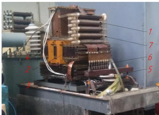
Рис 1. Установка для обробки імпульсними електричними полями 1 - багатозазорний розрядник; 2, 3, 4 - високочольтні конденсатори; 5 - робоча камера; 6 - металеві шпильки; 7 – захисний екран
