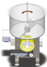
Рис. 1. Котлетний автомат формуючим барабаном
