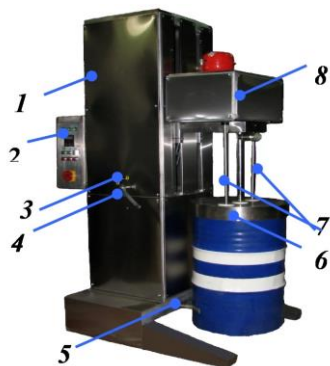
Рис.1. Загальний вид установки для нагрівання та плавлення в'язких основ “Термобат-М”: 1 – корпус з вантажопідйомним механізмом; 2 – шафа електроуправління; 3 – перемикач вантажопідйомного механізму; 4 – ручка лебідки; 5 – упор; 6 – термоконтактний нагрівач з кришкою; 7 – трубопроводи теплоносія; 8 – рухома каретка.
