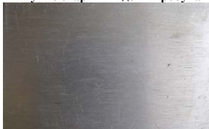
Рис. 4. Стан робочих поверхонь зразків сплаву В1341 після обробки методом «штучне старіння» після випробувань стійкості проти розшаровуючої корозії
