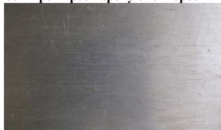
Рис. 4. Стан робочих поверхонь зразків сплаву В1341 після обробки методом «штучне старіння» після випробувань стійкості проти розшаровуючої корозії
