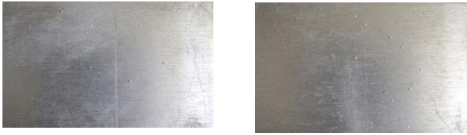
Рис. 6. Стан робочих поверхонь зразків сплаву В1341 у після обробки методом «штучне старіння» і загартування після випробувань стійкості проти розшаровуючої корозії
