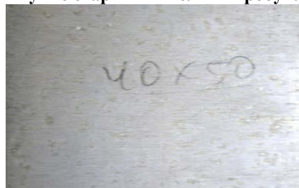
Рис. 5. Стан робочих поверхонь зразків сплаву В1341 після обробки методом «штучне старіння» і загартування до випробувань стійкості проти розшаровуючої корозії
