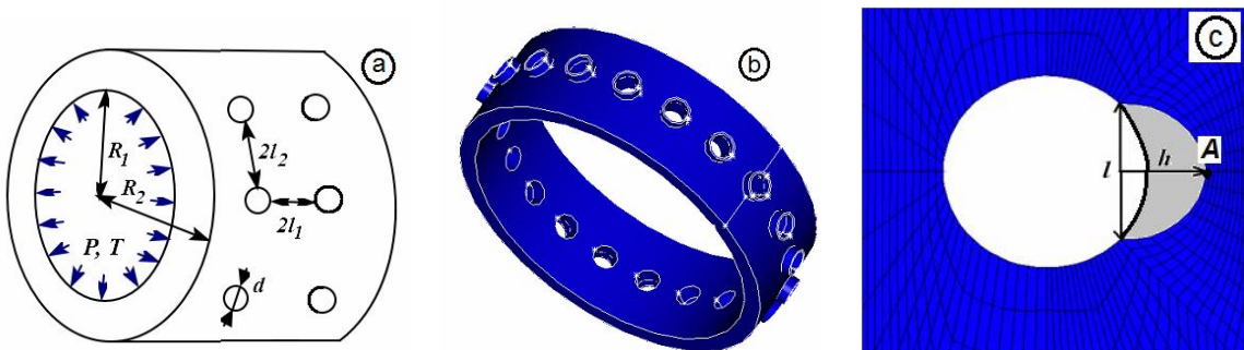
Рис. 2. Розрахункова схема (а) фрагменту барабана котла (б) за нестационарного термосилового навантаження з ремонтними “вибірками” (с).
