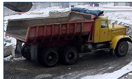
Рис. 3. Спецавтомобіль для перевезення радіоактивних відходів КрАЗ-256В-1
