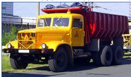
Рис. 3. Спецавтомобіль для перевезення радіоактивних відходів КрАЗ-256В-1
