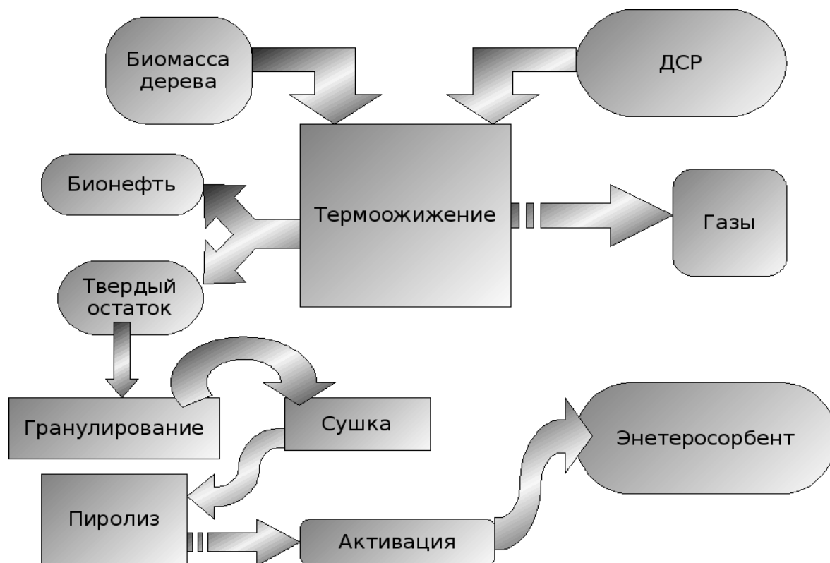
Рисунок 2: Принципиальная технологическая схема получения бионефти и энтеросорбентов.
