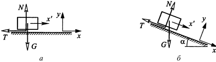
5 Схема ковзання тіла площиною.
