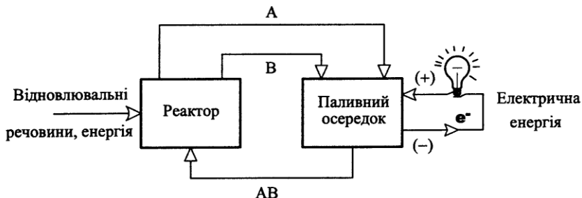
Рисунок 9.15 Загальна схема регенеративного паливного осередка.
