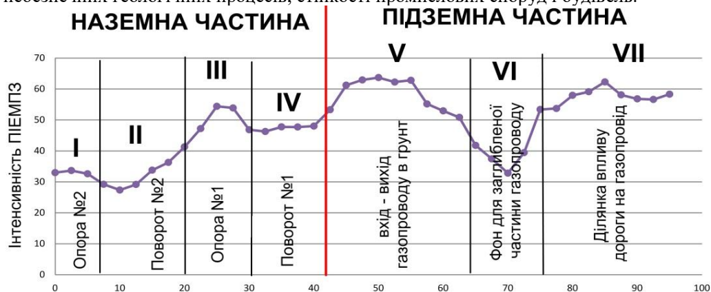
Рис. 2 Графік інтенсивності поля ( повний вектор Т ) уздовж нитки газопроводу УПУ
