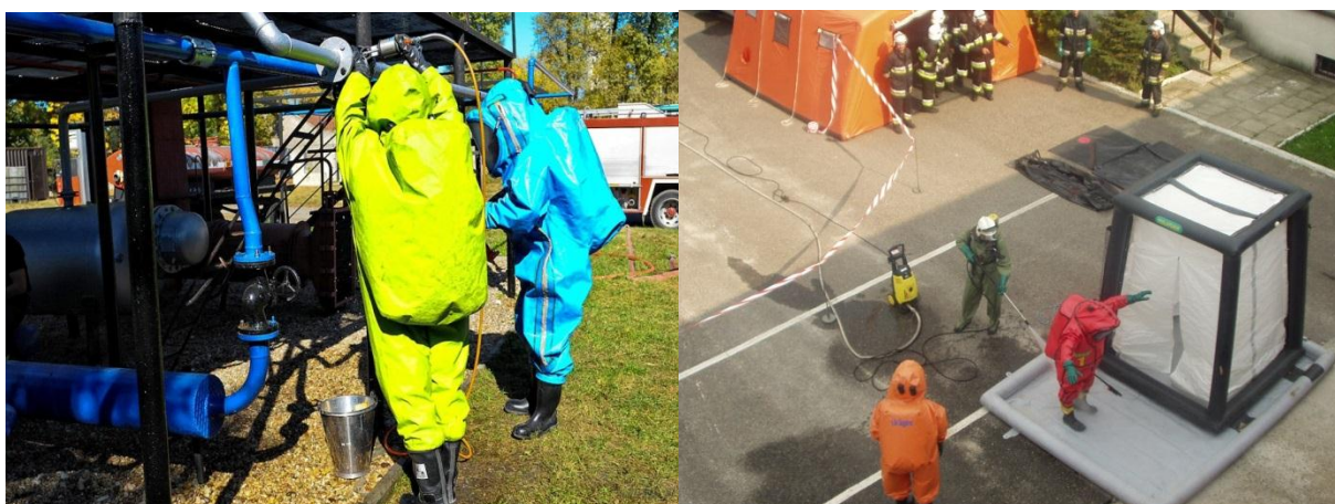
Рис. 3. Відпрацювання вправ на тренажері з використанням спеціального аварійно-рятувального обладнання для ліквідації хімічно небезпечних розлитих речовин із трубогонів чи ємностей
