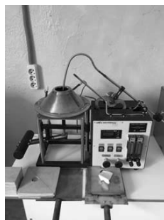
Рисунок 7 – Установка для определения воспламеняемости
