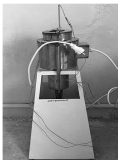
Рисунок 5 – Установка для определения негорючести материалов
