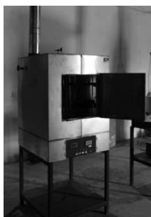
Рисунок 9 – Установка для определения коэффициента дымообразования
