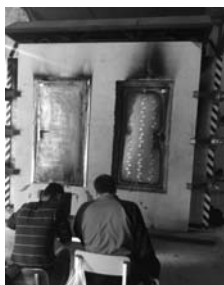
Рисунок 13 - Испытания дверей противопожарных на установке для определения огнестойкости дверей, ворот и несущих вертикальных перегородок
