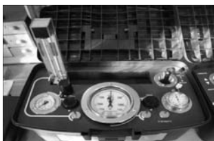
Рисунок 3 - Система контроля дыхательных аппаратов со сжатым кислородом
