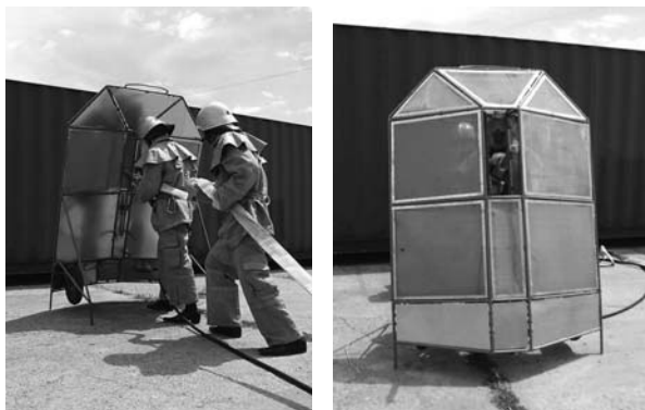
Рисунок 2 - Теплозащитный экран для оснащения подразделений службы пожарной безопасности «Согда-1А»
