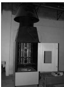
Рисунок 6 – Установка для определения группы горючести
