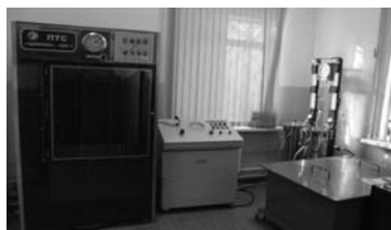
Рисунок 2 - Установка для исследования рабочих параметров автоматических систем, аппаратов и их элементов водяного и пенного пожаротушения
