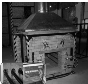
Рисунок 11 – Установка для испытания на огнестойкость проходки кабелей
