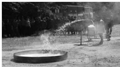
Рисунок 2 – Фрагменты сертификационных испытаний фторпротеинового пенообразователя а) 10 с. с начала подачи пены в очаг пожара, б) 40 с. с начала подачи пены в очаг пожара, наблюдается прекращение горения.
