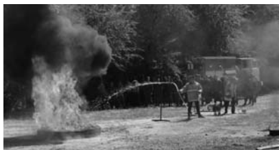
Рисунок 2 – Фрагменты сертификационных испытаний фторпротеинового пенообразователя а) 10 с. с начала подачи пены в очаг пожара, б) 40 с. с начала подачи пены в очаг пожара, наблюдается прекращение горения.
