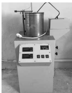
Рисунок 8 – Установка для определения температуры воспламенения и самовоспламенения
