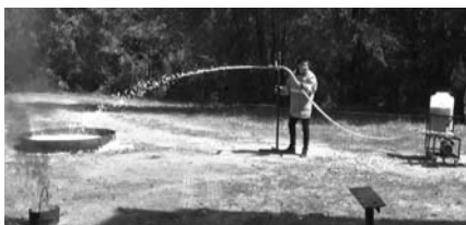
Рисунок 4 – Испытания качества пенообразователя с использованием установки для определения огнетушащей способности пенообразователей
