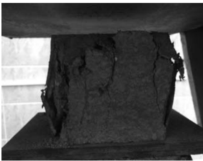
Рисунок 2 - Образец из бетона с добавкой полипропиленовой фибры после проведения эксперимента
