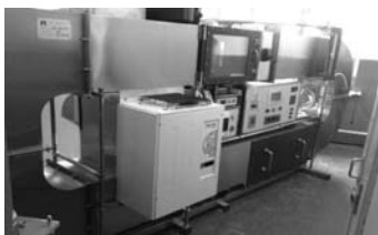
Рисунок 1 - Автоматизированная установка, для определения рабочих параметры любых типов пожарных извещателей
