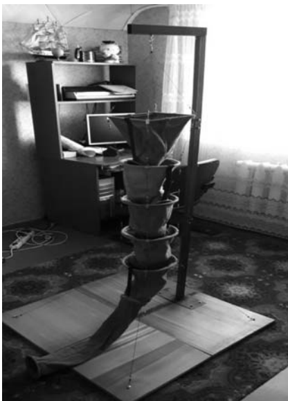
Рис. 5. Секционное устройство эвакуации в масштабе 1:20
