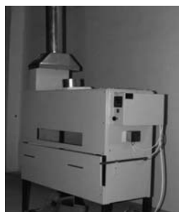
Рисунок 10 – Установка для испытаний на распространение пламени по поверхности покрытия полов и кровель
