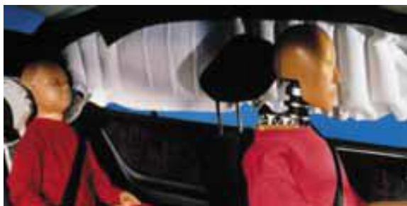
Рисунок 3.12 – Подушка безпеки типу «шторки»
