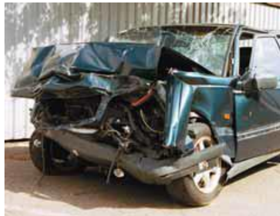
Рисунок 3.20 – Деформація завдяки зонам зім'яття
