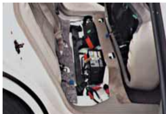
Рисунок 3.24 – Акумуляторні батареї під заднім сидінням
