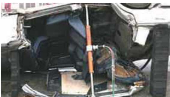
Рисунок 4.36 – Домкрат для створення вільного простору
