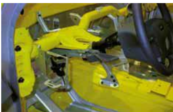
Рисунок 3.4 – Підсилювачі передньої панелі
