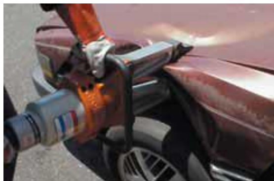
Рисунок 4.18 – Стиснення / розламування крила
