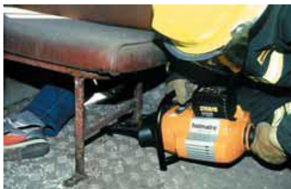
Рисунок 6.6 – Автономні аварійно-рятувальні інструменти добре працюють в обмеженому приміщенні автобуса
