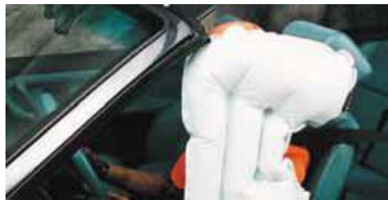
Рисунок 3.13 – Подушка безпеки, розташована в боковині крісла
