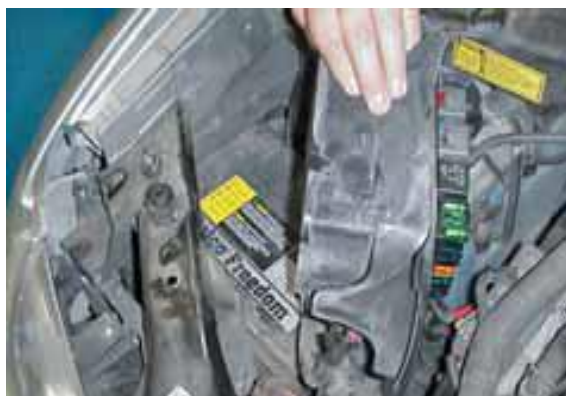
Рисунок 3.23 – Акумуляторні батареї в арці колеса
