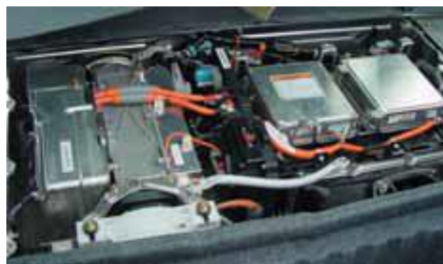
Рисунок 3.9 – Система блока АКБ Honda "Insight"
