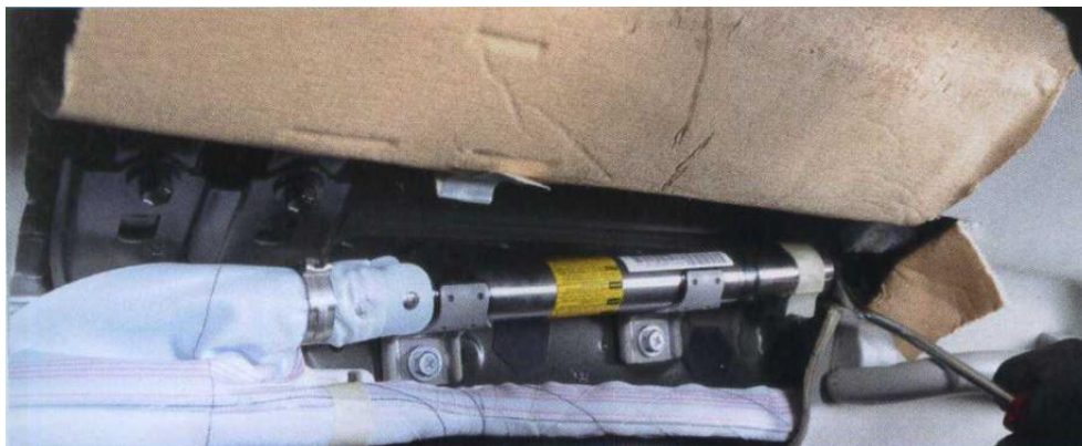
Рисунок 3.27 – Газовий балон шторок безпеки розташований в поздовжньому брусі даху кузова
