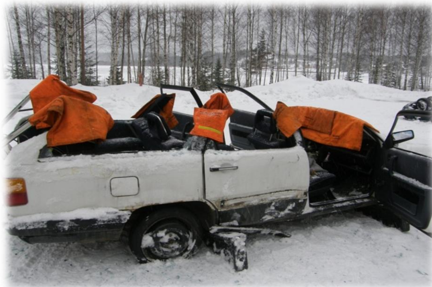
Рисунок 5.11 – Встановлення захисних засобів
