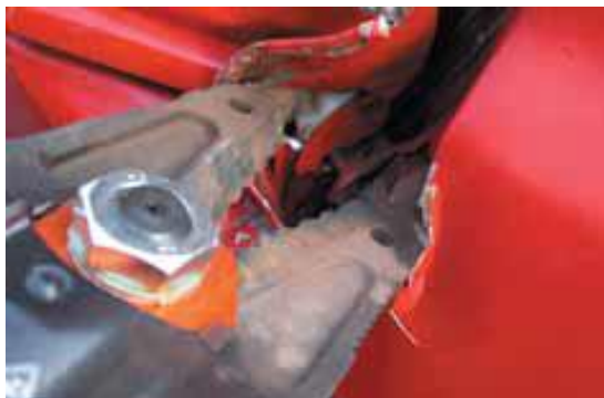
Рисунок 4.23 – Комбінований інструмент при відриванні
