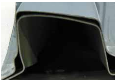
Рисунок 3.2 – Поперечний переріз середньої стійки, мод. 1996
