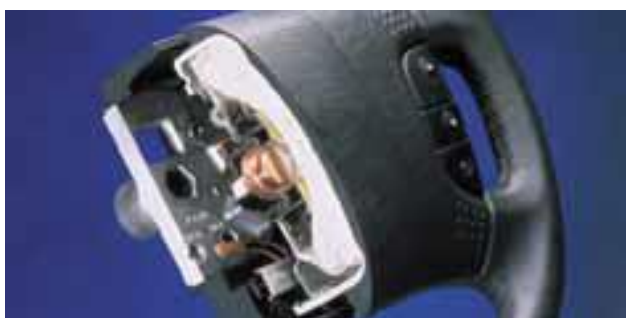
Рисунок 3.10 – Поперечний переріз нерозгорнутої передньої подушки безпеки
