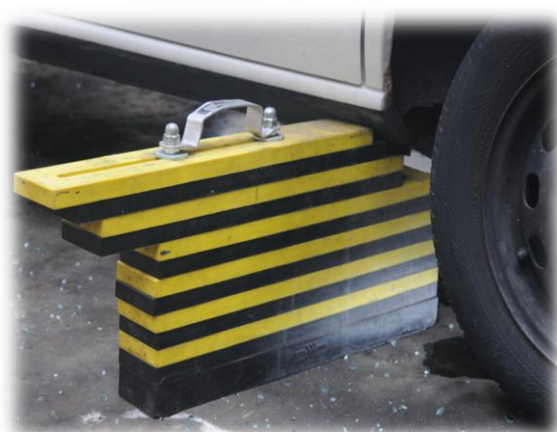
Рисунок 5.3 – Фіксація транспортного засобу, що стоїть на своїх колесах
