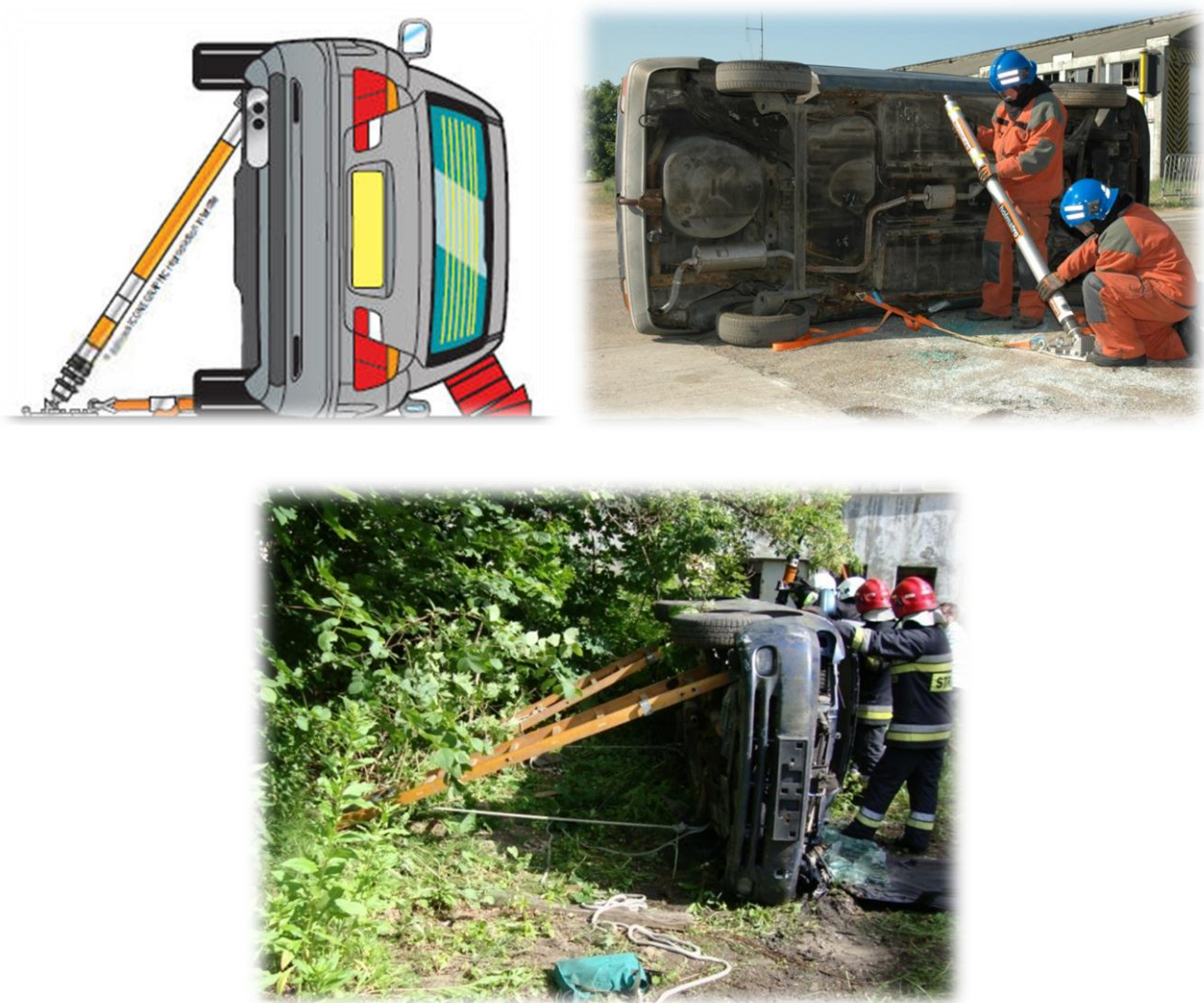
Рисунок 5.5 – Фіксація транспортного засобу, що перевернувся на бік
