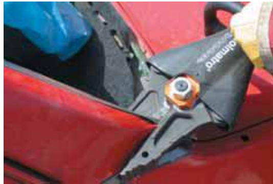
Рисунок 4.26 – Різання задньої стійки
