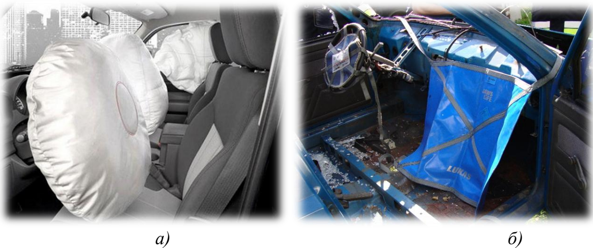
Рисунок 5.7 – Подушка безпеки в дії (а); захисні чохла (б)
