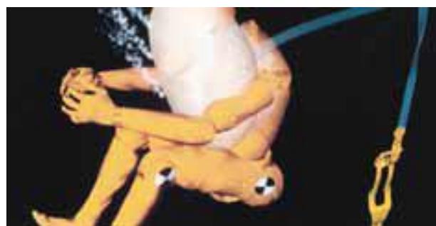
Рисунок 3.11 – Спрацювання передньої подушки безпеки
