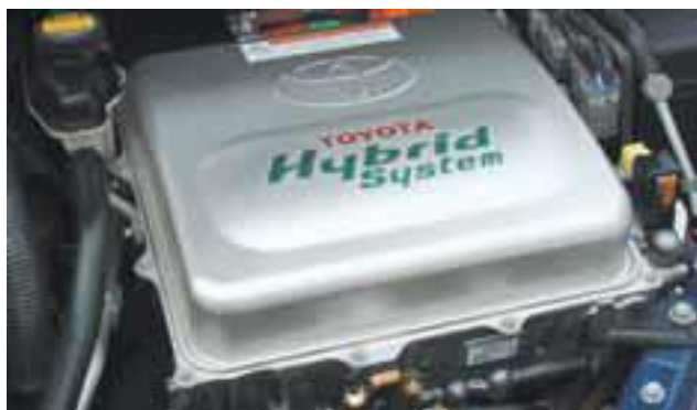
Рисунок 3.8 – Електронна приводна система Toyota "Prius"
