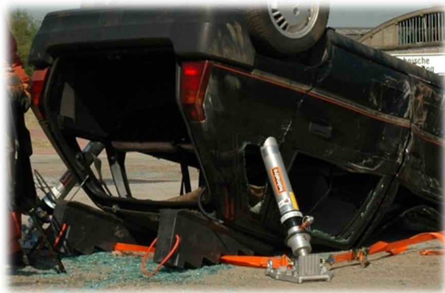
Рисунок 5.6 – Фіксація транспортного засобу, що перевернувся на дах
