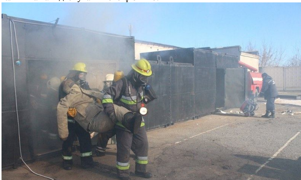
Рис. 1. Вогнева споруда для моделювання динамічно небезпечних чинників пожежі
