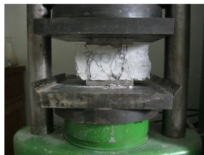
Рис. 12. Випробування половинки призми на міцність при стиску
