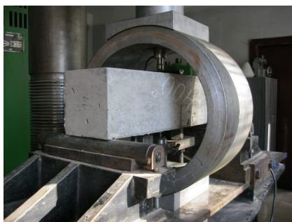
Рис. 11. Випробування призми на тріщиностійкість
