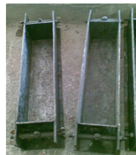
Рис. 4. Одномісна форма для виготовлення зразків у вигляді призми ФП – 100
