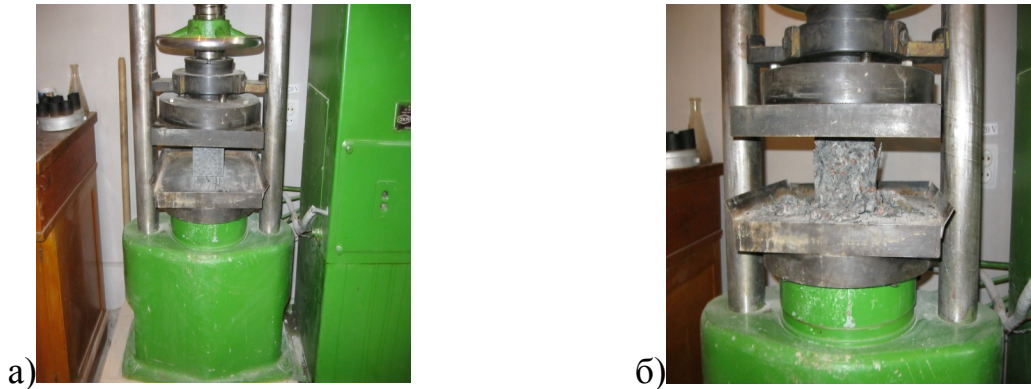
Рис. 2. Перевірка міцності на стиск контрольних зразків – кубів на гідравлічному пресі: а – до випробувань; б – на момент руйнування зразка
