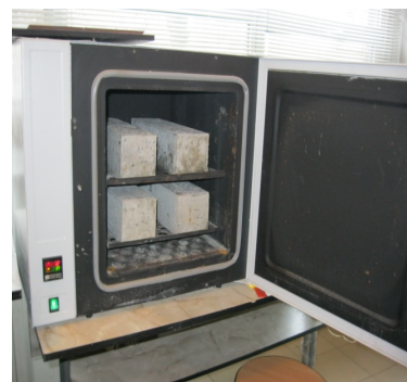
Рис. 7. Витримка зразків у електричній муфельній печі: а) в робочому режимі; б) у момент завантаження зразків
