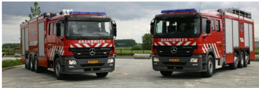
Рисунок 10 — Пожежно-рятувальні автомобілі на шасі Mercedes Benz Actros 8×4 та 8×2
