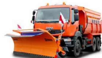
Рисунок 31 — Автомобілі з снігоочисниками: а) активним; б) пасивним
