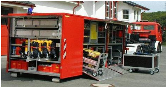
Рисунок 30 — Варіанти мініконтейнерів на коліщатах та їх розміщення в контейнерах
