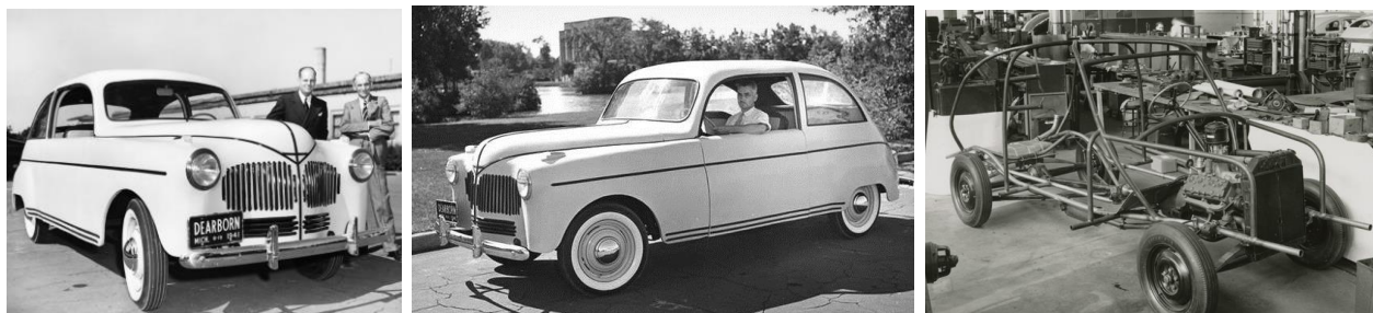
Рисунок 2 — Дослідний автомобіль Ford з пластмасовим кузовом
