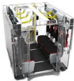
Рисунок 23 — Модульна кабіна TEAM Cab Magirus
