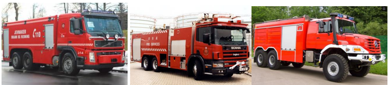
Рисунок 11 — Пожежно-рятувальні автомобілі на шасі Volvo FM 6×2, Scania P124 6×4 та Mercedes Benz Zetros 6×6
