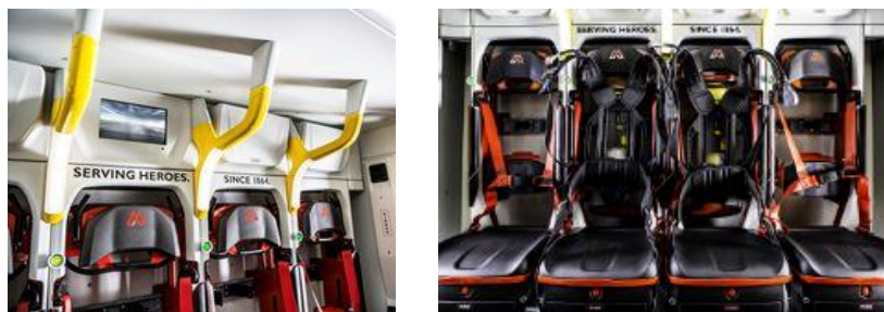
Рисунок 16 — Кабіна бойового розрахунку з системами пасивної безпеки
