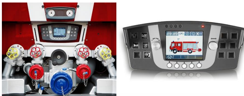
Рисунок 17 — Помповий відсік з основною панеллю керування (ліворуч) та дублююча панель керування (праворуч)
