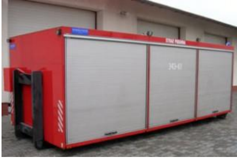
Рисунок 29 — Багатофункційний кузов фургон: а) з дверима шторного типу; б) з дверима «крила метелика»
