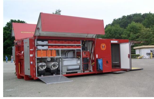
Рисунок 29 — Багатофункційний кузов фургон: а) з дверима шторного типу; б) з дверима «крила метелика»
