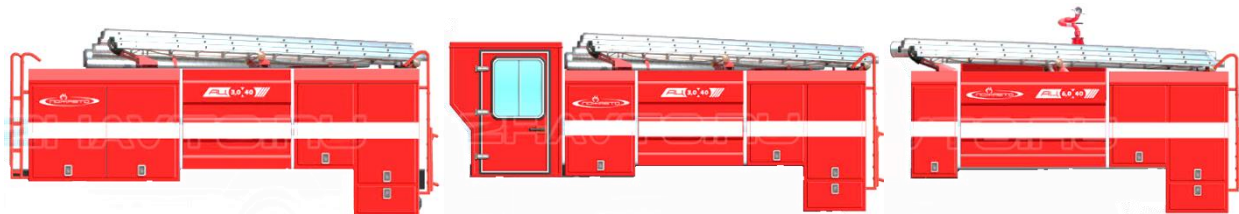
Рисунок 25 — Пожежні надбудови модульного типу UNIMOD
