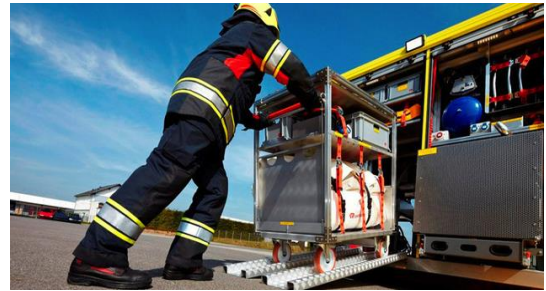
Рисунок 30 — Варіанти мініконтейнерів на коліщатах та їх розміщення в контейнерах
