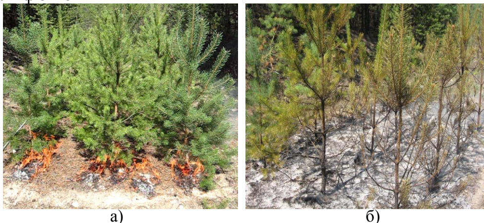
Рисунок 3 – Фото розповсюдження імітаційної пожежі на штучно сформованій ділянці соснових насаджень у віці 8 років: а – на 10 с від початку підпалу; б – після завершення пожежі тривалістю 180 с
