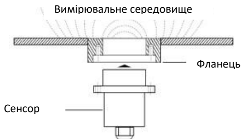
Рисунок 1 – Принцип дії вологоміра M-Sens 2
