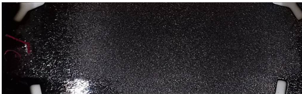
Рис. 1– Пленка железа, нанесенная на стеклянную подложку при минимальной скорости испарения
