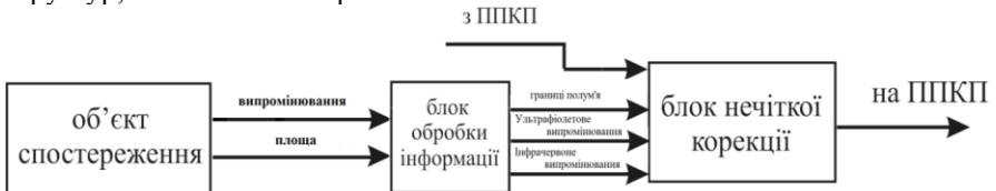
Рисунок 2 – Структурна схема пожежного сповіщувача полум’я
