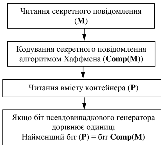
Рис. 1. Алгоритм приховування секретного повідомлення
