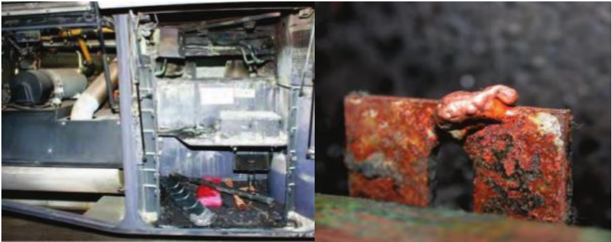
Рисунок 1.13 – Зовнішній вигляд автобуса після пожежі, причиною якої стало КЗ
