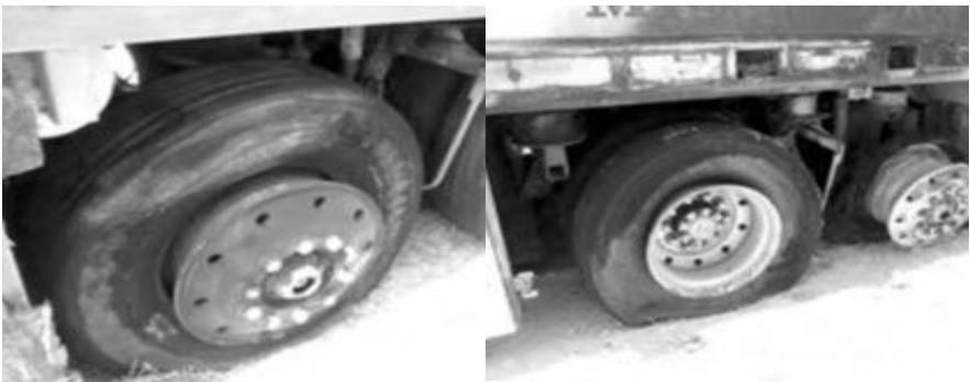
Рисунок 1.14 – Зовнішній вигляд колеса автобуса, яке стало причиною пожежі
