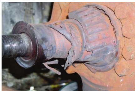
Рисунок 1.15 – Зовнішній вигляд автобуса під час пожежі, причиною якої став вихід з ладу підшипників осі маточини колеса
