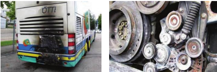
Рисунок 1.11 – Зовнішній вигляд автобуса після пожежі та генератора, який став її причиною
