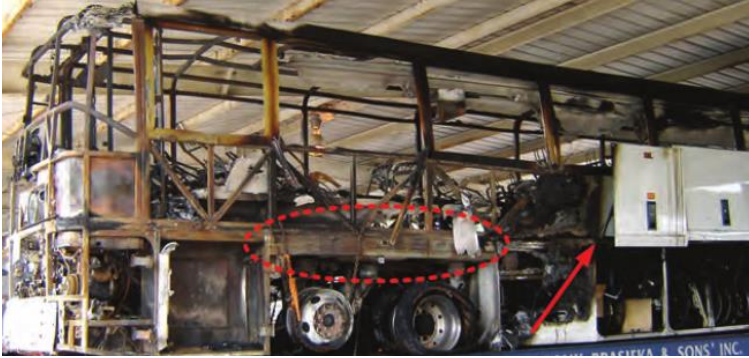
Рисунок 1.16 – Зовнішній вигляд автобуса після пожежі, причиною якої став вихід з ладу підшипників осі маточини колеса
