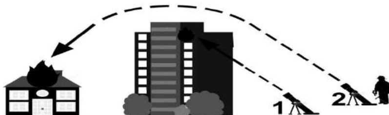
Рис. 1. Зображена подача вогнегасної речовини з безпечної відстані за допомогою стволової установки дискретної подачі контейнера (ємності)
