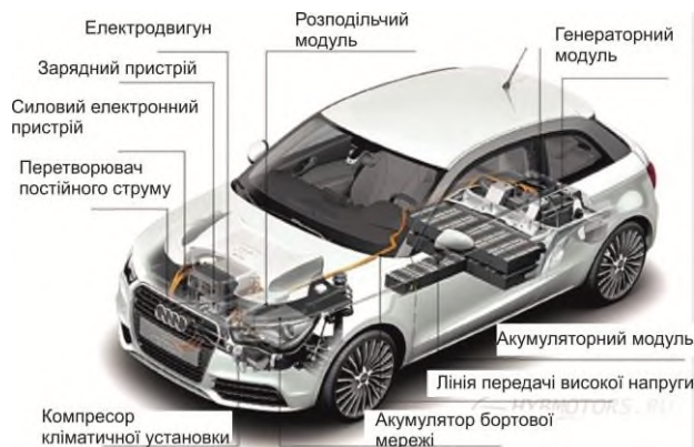
Рисунок 1 – Конструктивна схема електрокара
