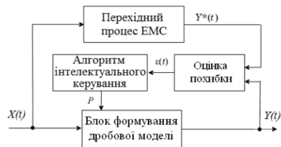
Рисунок 1 – Функціональна схема процедури апроксимації цілочисельної передавальної функції високого порядку дробовими моделями за використання інтелектуальних методів
