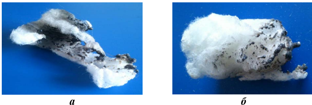
Рисунок 1 – Образцы полиэфирного нетканого утеплителя после огневого испытания: а– исходного материала, б – после ступенчатой огнезащитной обработки
