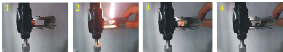
Рисунок 2 – Тушение пламени с помощью постоянного магнитного поля: 1 – набор неодимовых магнитов; 2-4 – последовательные фазы процесса тушения
