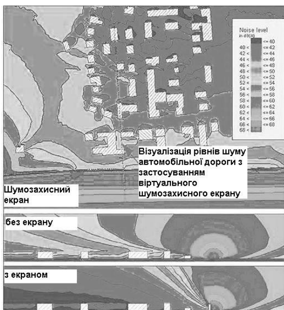
Рисунок 3 – ситуаційна шумова карта автомобільної дороги без шумового екрану і з застосуванням віртуального шумового екрану
