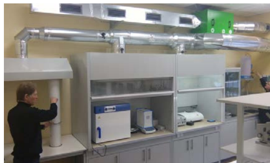
Рисунок 3 – Установка для досліджень аеродинамічних процесів в трубах КУ і ТД – лабораторна стійка-трансформер, на базі якої можуть збиратися різні вимірювальні та випробувальні стенди відповідно до завдань досліджень (рис. 4);
