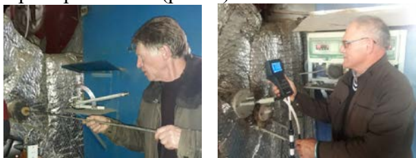
Рисунок 8 – Контроль швидкості і витрати потоку та токсичності димових газів КУ
