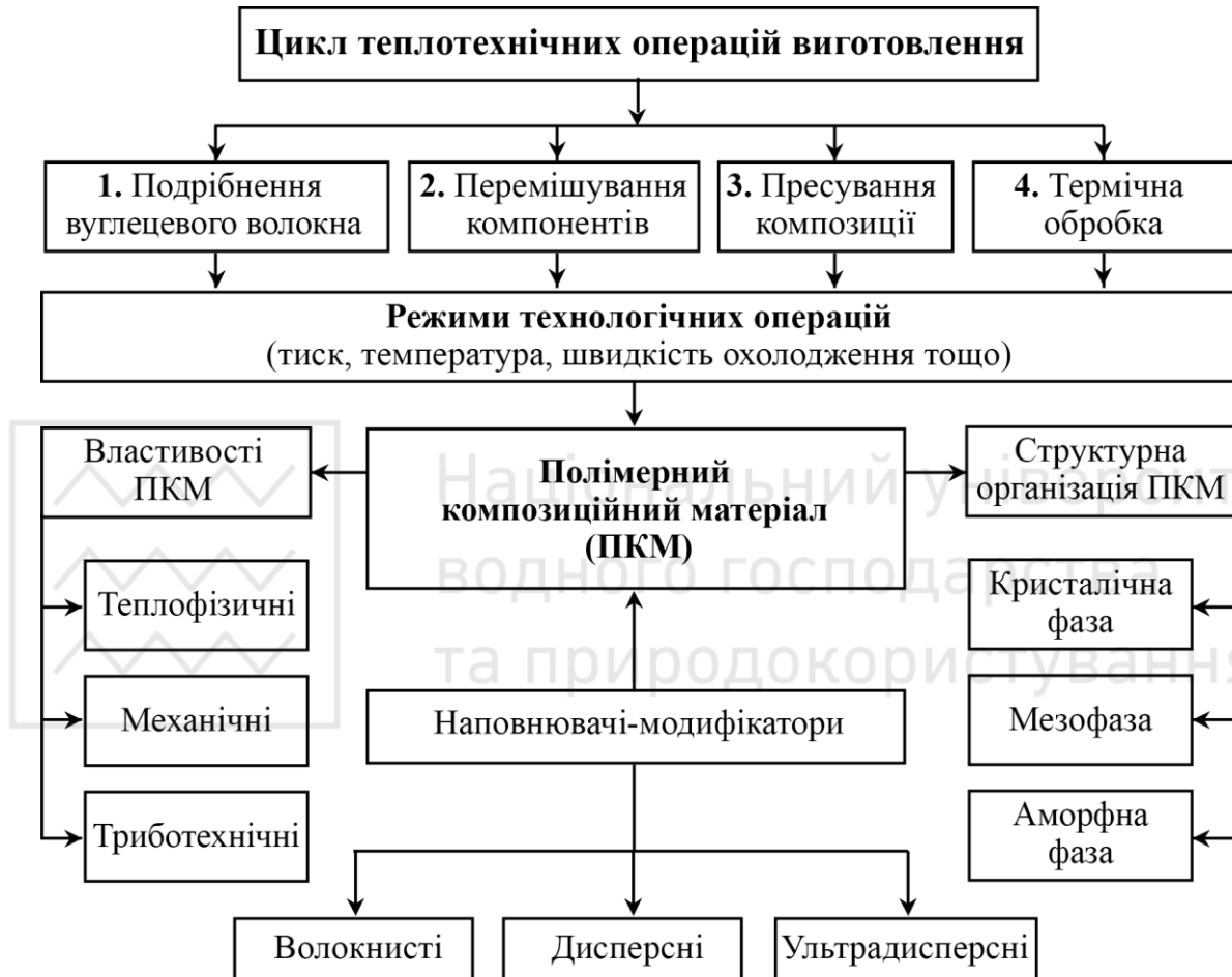
Рис. 1. Структурно-технологічна модель процесу формування складу, структури та властивостей полімерного композиційного матеріалу (ПКМ) графелон
