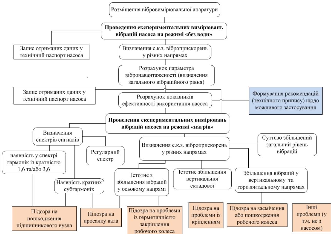
Рисунок 12 – Схема методики проведення вібраційної діагностики технічного стану відцентрових пожежних насосів
