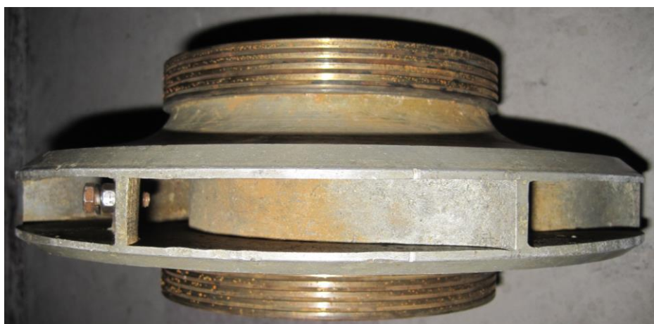
Рисунок 4.1 – Фото встановлення до робочого колеса насоса додаткової маси, що імітує потрапляння стороннього тіла та викликає додатковий дисбаланс
