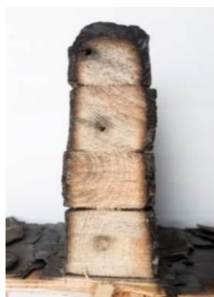
Рисунок 1 – Схема вимірювання геометричних параметрів обвуглювання зони фрагменту
