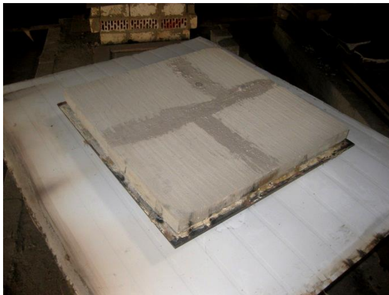
Рисунок 3.30 - Фото візуального стану пінобетонної плитки марки D800 після випробування
