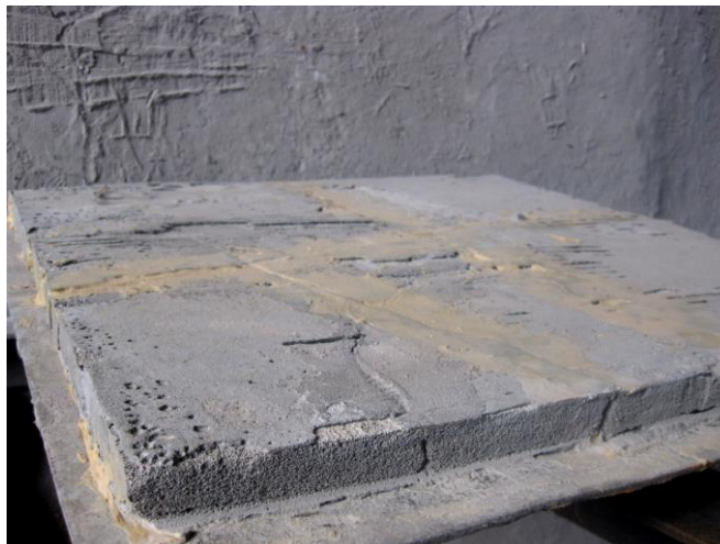
Рисунок 3.24 - Фото візуального стану газобетонної плити марки D800 до проведення випробування
