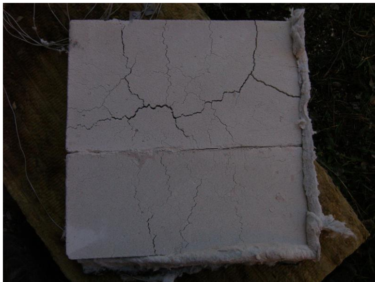
Рисунок 3.4 - Фото візуального стану газобетонної плитки марки D400 після проведення випробування
