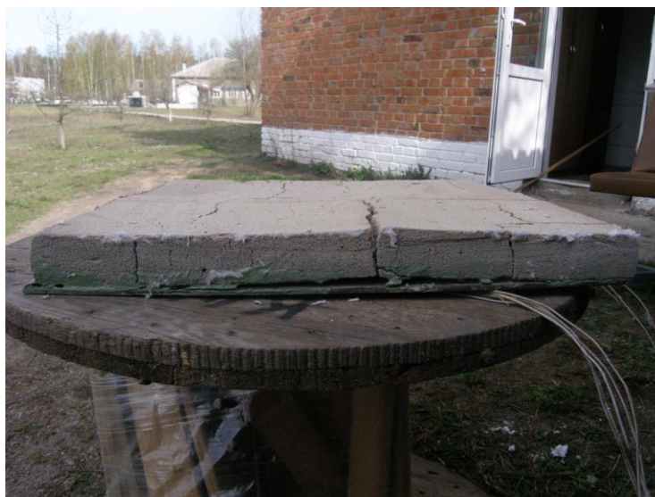
Рисунок 3.15 - Фото візуального стану пінобетонної плитки марки D800 після проведення випробування
