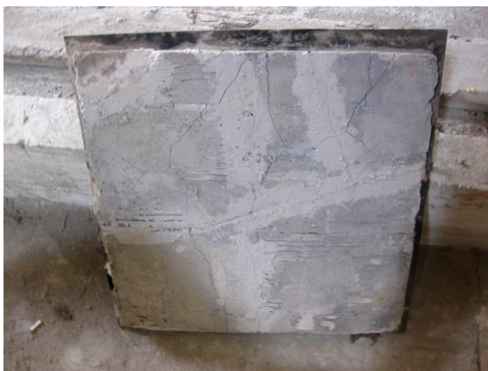
Рисунок 3.25 - Фото візуального стану пінобетонної плити марки D800 після випробування
