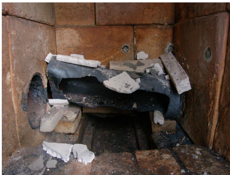
Рисунок 3.20 - Фото візуального стану пінобетонної плитки марки D800 після випробування
