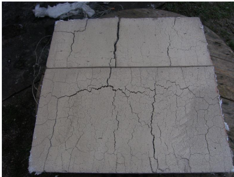
Рисунок 3.14 - Фото візуального стану пінобетонної плитки марки D800 після проведення випробування
