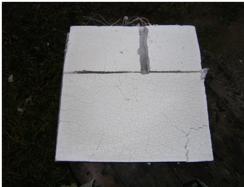
Рисунок 3.9 - Фото візуального стану газобетонної плитки марки D500 після проведення випробування
