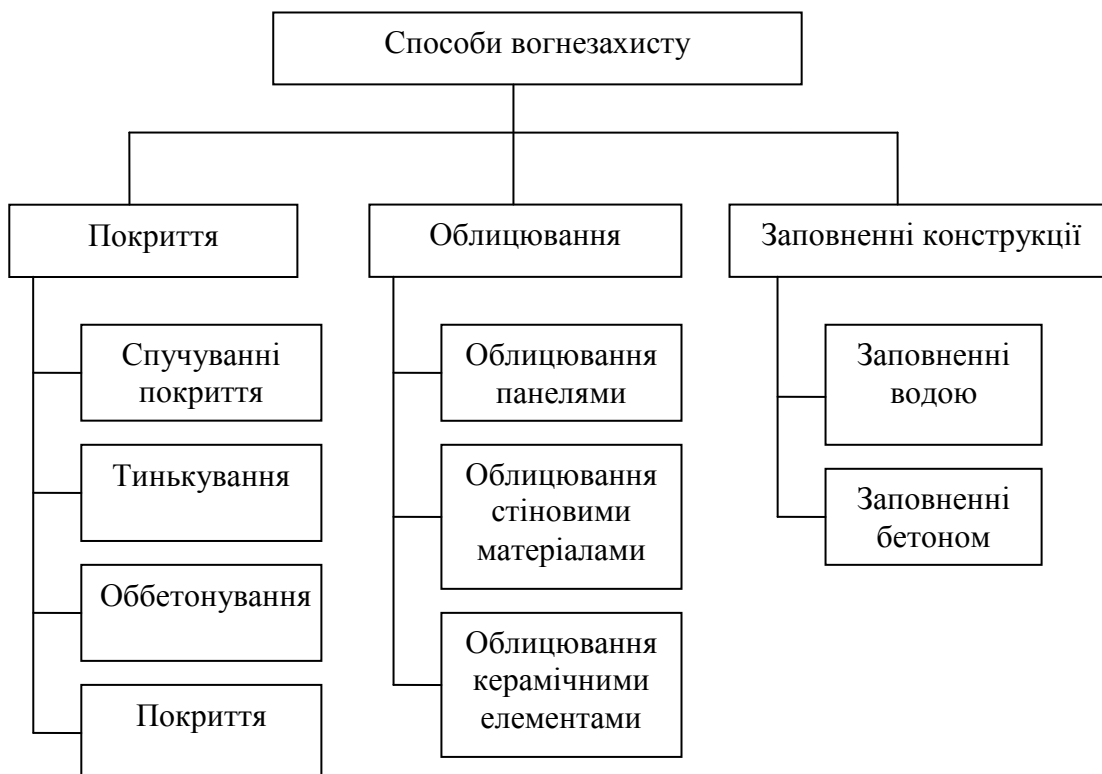
Рисунок 1.3 - Способи підвищення вогнестійкості сталевих конструкцій
