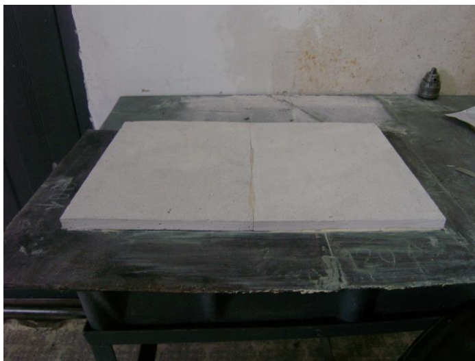
Рисунок 3.19 - Фото візуального стану газобетонної плитки марки D800 до проведення випробування
