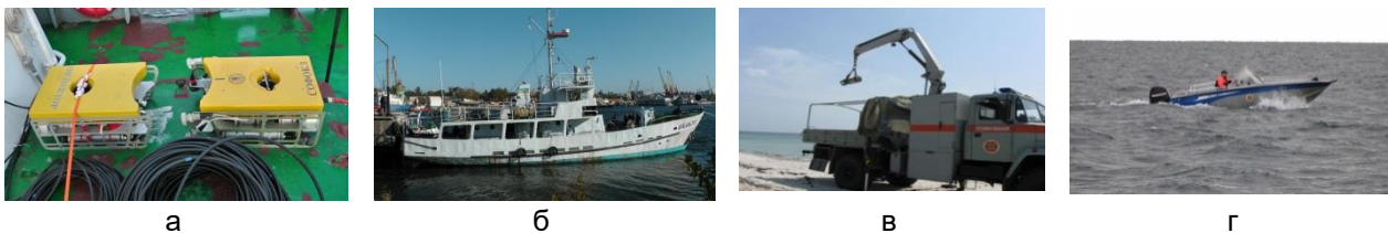
Рисунок 1 – Технічні засоби НУК та ГУ ДСНС, які залучались до пошуку та обстеження ППНО: а – підводні апарати НУК «Інспектор» і «Софокл»; б - науково-дослідне судно НУК «Дельта»; в – автомобіль розмінування ГУ ДСНС; г – моторний катер-носій водолазів-саперів ГУ ДСНС
