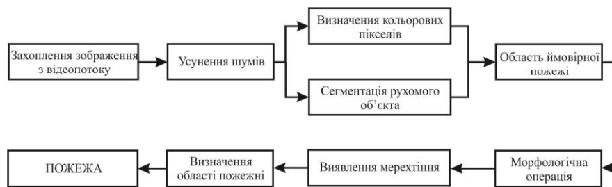
Рисунок 1. Структурна схема алгоритму роботи системи виявлення пожеж на основі комп'ютерного зору
