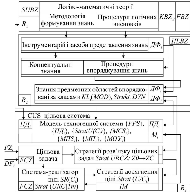
Рис. 5. Блок-схема розв'язку проблемної ситуації при взаємодії бази знань і цілеспрямованої системи: SUBZ – система управління базою знань, KBZ Л – концептуальна база знань логічних правил, HLBZ – дисплейний комплекс, ДФ і – інформаційні потоки даних, KL[MOD] – класи моделей динаміки і структури об'єктів управління, CUS – цільова система, HO і – модель об'єкта, FLZ – формулювач цільової задачі, DF і – директивні фактори, FZ і – фактори збурення, Strat U: Z 0 –Z C – стратегія переходу системи в цільову область, SR(C і ) – система-реалізатор цілі, Strat(U/L і ) – стратегія цільового управління, рівні ієрархії R і – база знань, R 2 – інженерія знань, R 1 – цільове управління, FPS – формулювач проблемної ситуації, {ПД і } – потоки даних, Strat U і – стратегії, {МПС і } – модель простору цілей, {МІС і } – модель простору станів, {МІР і } – модель простору шаблонів режиму
